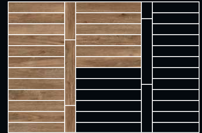
Leiterboden-Verlegung Ladder pattern
